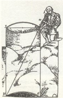
Fig. 9 - "Oronce Finé. Medir con un cuadrante la profundidad de un pozo, en la edición de J. Girava, 1533. Biblioteca Nacional." [Imagem 14, p.50, DT, 2015].
